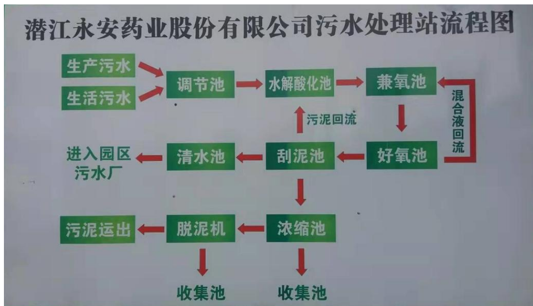
图3.6-1 污水处理工艺流程图
